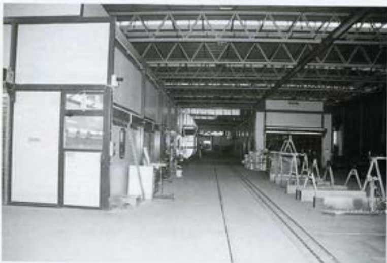
Fig. 4 - A sinistra l'impianto di applicazione di fondi e smalti all'acqua sui rimorchi delle superfici precedentemente granigliate a metallo bianco: lungo oltre 70 m, corre parallelo al secondo impianto per verniciatura di particolari avente dimensioni minori della metà del primo
