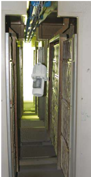
Fig. 8 - Il pezzo con la polvere fusa sta raggiungendo il forno di reticolazione UV
