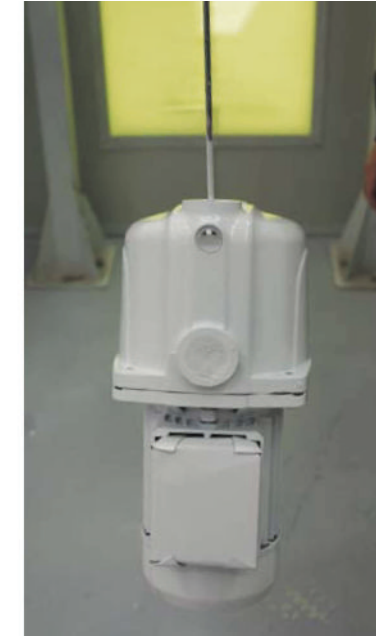
Fig. 9 - Renzo Scavini controlla la bassa temperatura del pezzo all'uscita del forno di cottura UV: l'idropompa è completamente assemblata anche con motore e cavi elettrici
