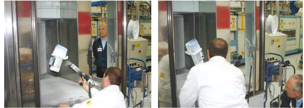
Fig. 2 - A sinistra, particolare di spruzzatura polveri di una idropompa composta da quattro materiali diversi: la testa in ghisa, il motore allettato in alluminio, il rotore in acciaio, la scatoletta dei comandi elettrici in alluminio; in secondo piano Renzo Scavini della Savim, promotore dell'iniziativa UV
