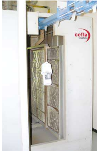
Fig. 6 e 7 - I pezzi sono trasportati nel forno a raggi infrarossi per la fusione delle polveri (2 min circa)
