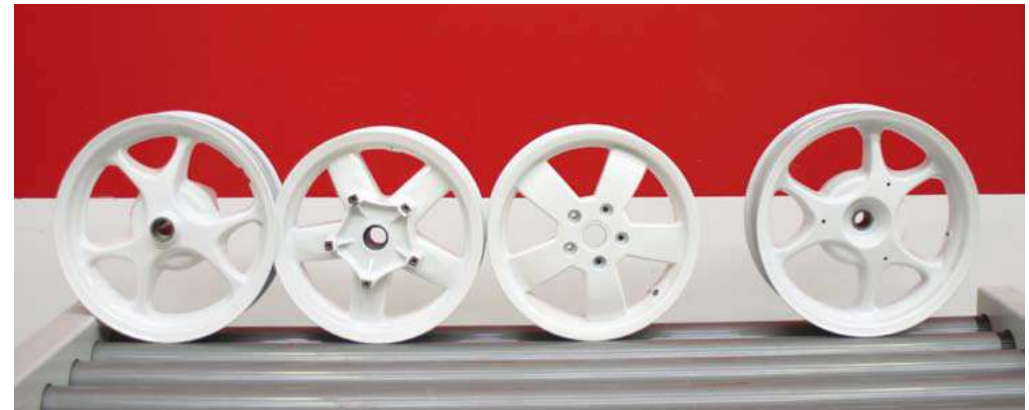
Fig. 11 - Ruote di scooter rifinite, dopo trattamento nanotecnologico, con polveri UV
