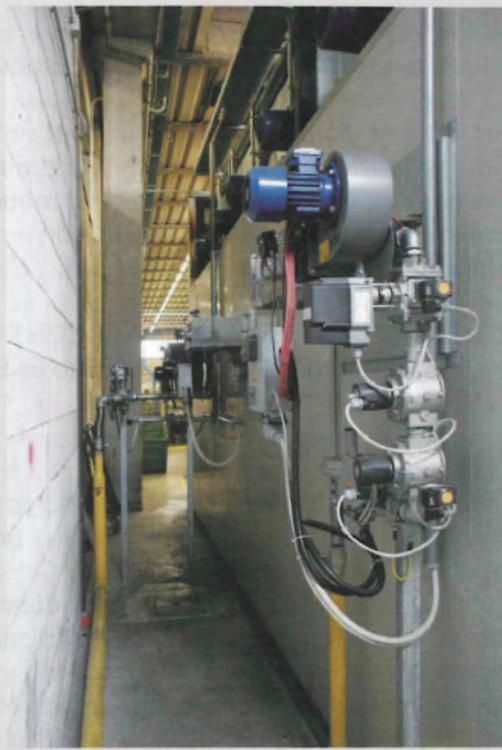
2 - Particolare dei due bruciatori in vena d'aria per il forno di cottura.
