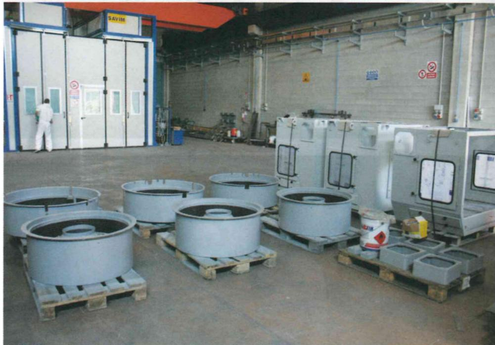
**6 - Le cabine di verniciatura della Savim, fornite di vernici dalla centrale di erogazione, posizionata tra le due.**
