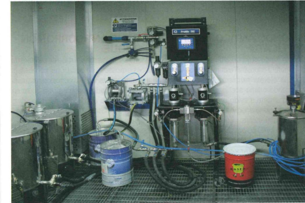
**8 - Sotto a sinistra, la centrale di erogazione vernici alle due cabine poste lateralmente: si noti a destra il solo indurente per il fondo e le finiture.**
