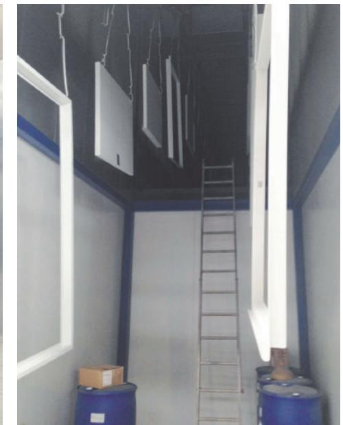
14 - Particolare dell'interno del forno aereo
