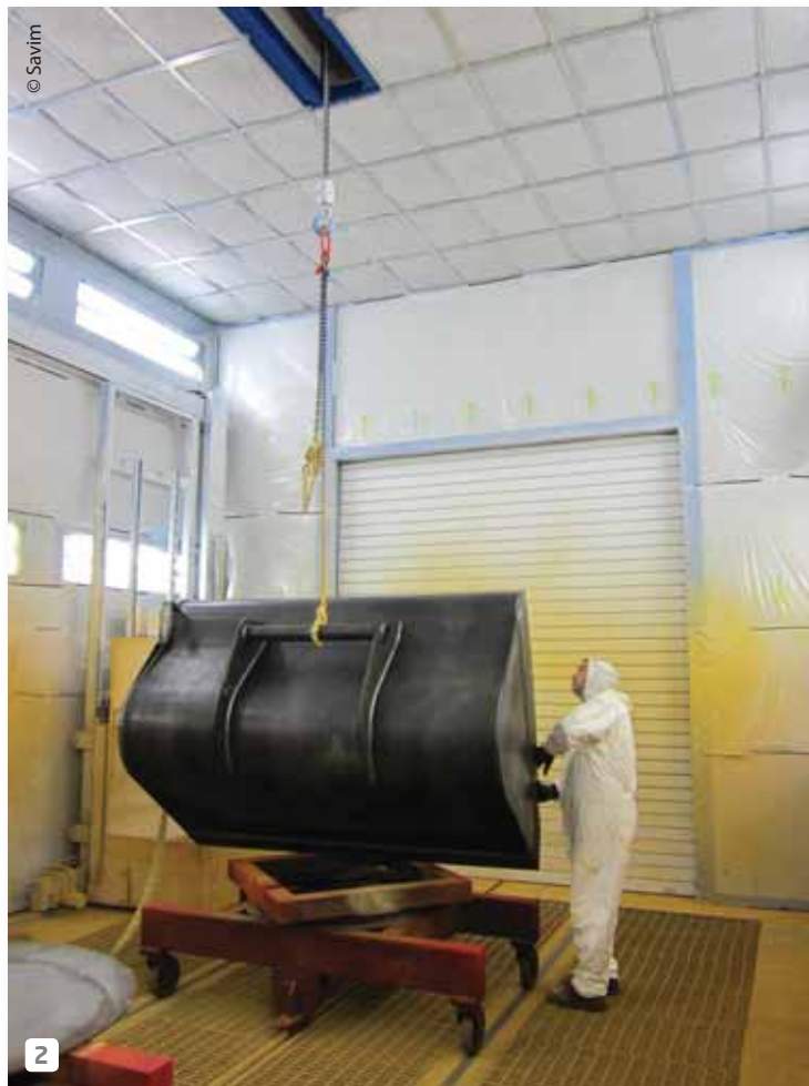
2 A bucket hanging from a pulley installed in the coating booths. Una benna agganciata a uno dei paranchi installati per le cabine di verniciatura.
