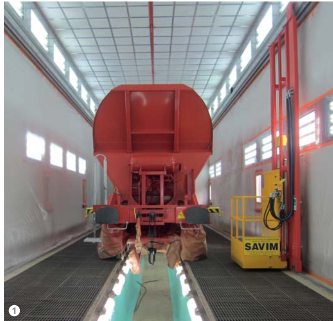
Figura 1: La cabina di verniciatura diventa una serie di cabine uguali, una di seguito all'altra senza alcuna separazione tra le stesse.
