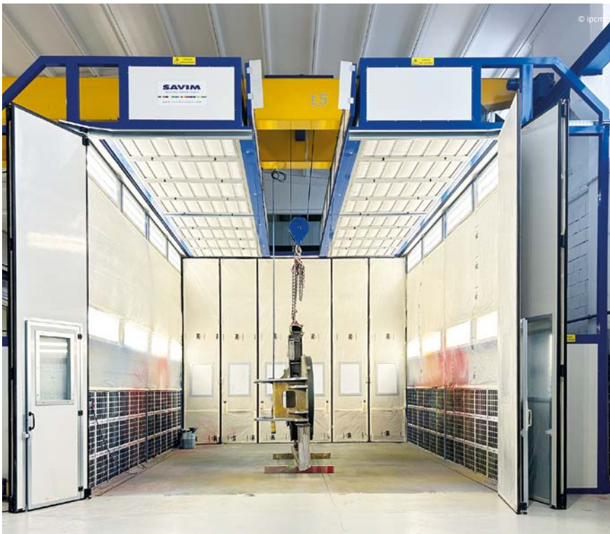
La cabina-forno di verniciatura di Savim Europe divisa in tre sezioni gemelle dai portoni.
